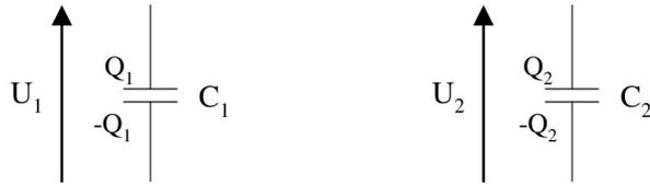
1. La différence de potentiel aux bornes du condensateur de gauche de capacité  $C_1 = 1 \mu\text{F}$  vaut  $U_1 = 10 \text{ V}$ . Calculer la charge  $Q_1$  du condensateur.
